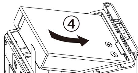
☰ Ziehen Sie das Band leicht nach oben, um die Batterien zu entfernen. Beim Einlegen der Batterie, falten Sie das Band nicht unter die Batterie.
