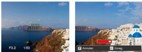
4. Faire tourner la caméra en fonction de la direction de consigne. Lorsque la plage de rotation ne dépasse pas la plage que la caméra peut détecter, la boîte de dialogue de progression le long de la flèche d'Indication se transforme partiellement en rouge. Quand il devient tout rouge, le mode prise de vue panoramique est terminé.
