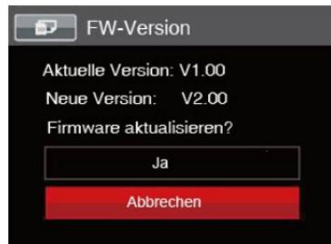
4. Wenn sich eine Datei mit einer neuen Firmware-Version auf der Speicherkarte befindet, wählen Sie [Ja] zum Aktualisieren.
