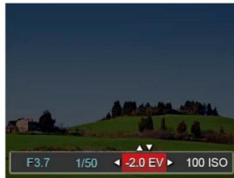
Der Lichtwert (Exposure Value, EV) ist im Bereich von -2,0 bis +2,0 einstellbar.
