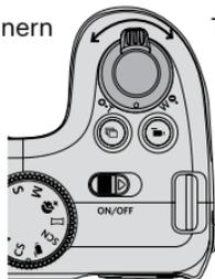
1. Verschieben Sie den Zoom-Hebel, um zwischen der Miniaturansicht mit 3x3 oder 4x4 Bildern zu wechseln.
