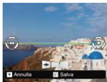
4. Quando termini di scattare la prima foto, due icone obiettivo verranno visualizzate sullo schermo LCD ai lati sinistro e destro. Quando sposterai la fotocamera fino a quando l'icona guida rotonda di direzione e il quadrato di posizionamento diventano verdi, essi si sovrapporranno e la fotocamera farà automaticamente un'altra foto. Ripetendo le stesse azioni puoi fare fino a 4 foto.
