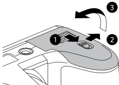
2. Inserire la batteria osservando la polarità corretta. Usare il lato della batteria per premere l'otturatore come mostrato, permettendo alla batteria di bloccarsi correttamente in posizione.
