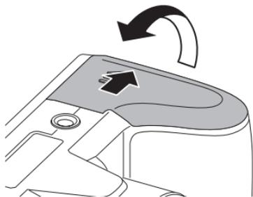
2. Inserire la batteria osservando la polarità corretta. Usare il lato della batteria per premere l'otturatore come mostrato, permettendo alla batteria di bloccarsi correttamente in posizione.
