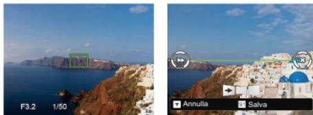
4. Quando termini di scattare la prima foto, due icone obiettivo verranno visualizzate sullo schermo LCD ai lati sinistro e destro. Quando sposterai la fotocamera fino a quando l'icona guida rotonda di direzione e il quadrato di posizionamento diventano verdi, essi si sovrapporranno e la fotocamera farà automaticamente un'altra foto. Ripetendo le stesse azioni puoi fare fino a 4 foto.
