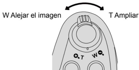
1. Deslice la palanca de zoom para cambiar a 3x3 y 4x4 miniaturas.
