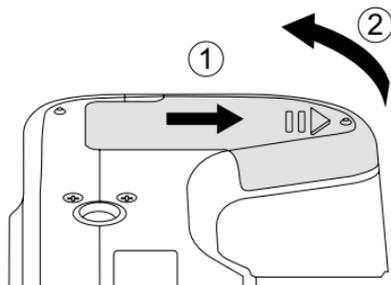
2. Inserte la batería en la ranura de la batería en la correcta posición como se muestra en el diagrama.
