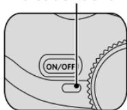
3. Si está apagada, también puede cargar la cámara conectándola a su equipo mediante un cable USB.
