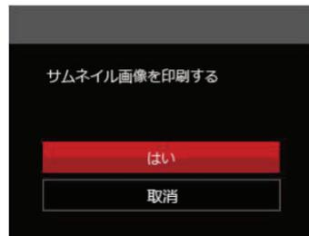
2. [はい] を選択すると印刷が開始します。[取消] を選択すると、印刷をキャンセルします。**SET** ボタンを押して、設定を確定します。
