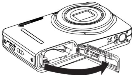
2. 電池のプラスとマイナスを確認しながら、電池の側面を使用してストッパーを矢印方向に逃がし、電池を正しく装填します。
