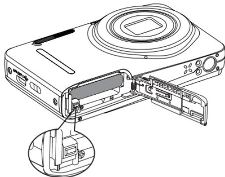
3. 図に示すように、メモリーカードをメモリーカードスロットに装填します。
