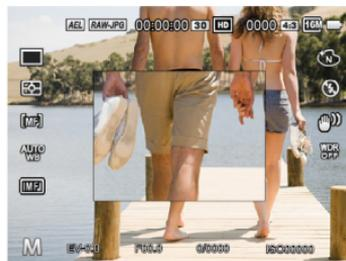
自動+手動フォーカスを設定したときの拡大焦点ズーム枠は、センターAFとマルチAFをAFエリアで設定したときのみ画面に表示されます。
