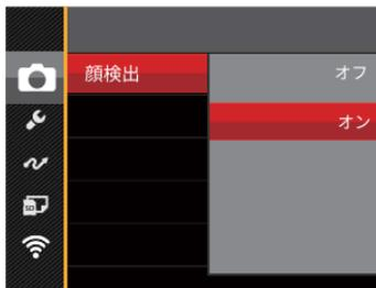
1. カメラを構えて、被写体に向け顔を検出すると、液晶モニターの顔部に白枠のフレームが表示されます。
