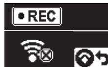
が LCD に表示されている時に ボタンを押すと Wi-Fi 接続を終了することができます。接続終了確認画面で / ボタンで **YES** を選択し、 ボタンで決定してください。
