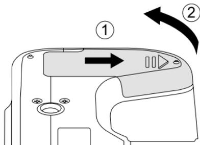
2. 將電池依圖示方向正確裝入電池槽中。
