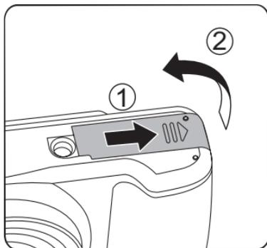
2. Inserire la batteria nello scomparto batterie secondo le polarità negativa e positiva come illustrato nell'immagine. Spingere la batteria verso il basso finché non scatta in posizione.
