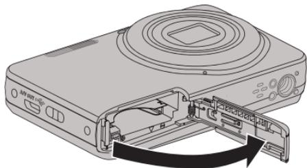
2. Achten Sie beim Einlegen des Akkus auf die richtige Polarität. Der Akku muss soweit in den Schacht eingefügt sein, dass der gelbe Schieber oberhalb des Akkus einrastet und ein Herausfallen des Akkus verhindert. (wie in der Grafik abgebildet)
